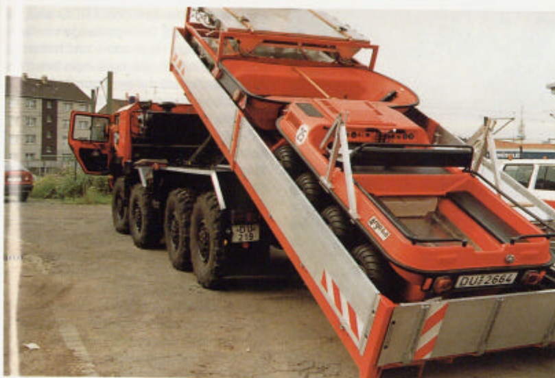
1 MAN 8 x 8-Wechseladerfahrzeug mit Abrollbehälter „ARGO 8 x 8“.
