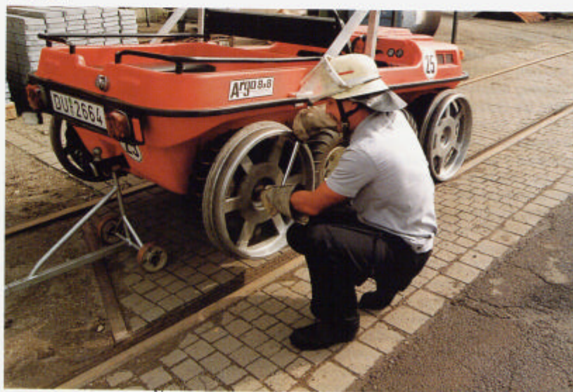
2 ARGO wird mit einem Hebelwagenheber angehoben, die Schienenräder auf die Radnabe gesteckt und mit einer Schraube gesichert.
