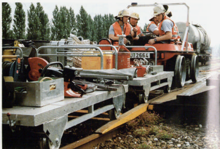
4 Die Schienentransportwagen sind in Aluminium-Leichtbauweise ausgeführt und für den Hand(schub)betrieb sowie für den Anhängerbetrieb geeignet.
