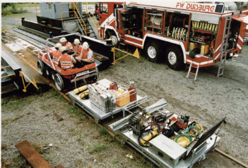
3 ARGO mit 2 Schienentransportwagen im Zugverband. Die Beladung erfolgt individuell entsprechend dem Einsatzgeschehen.
