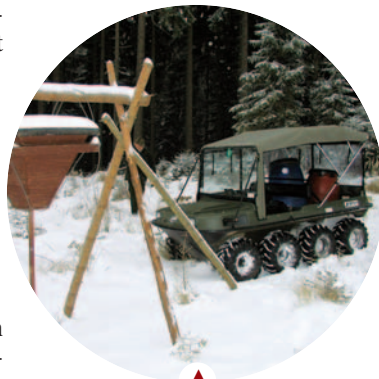
Argo 8x8 im winterlichen Einsatz. Im Extremfall kann er mit Raupenkettchen ausgestattet werden.
