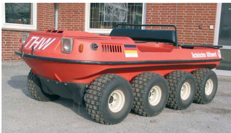
Das Amphibienfahrzeug ARGO Magnum 8x8 zeichnet sich durch eine hohe Geländegängigkeit aus, außerdem ist es schwimmfähig.
