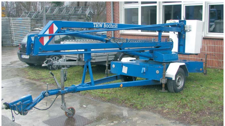
Wenn es mal hoch hinaus gehen soll, dann steht den Bocholtern ein Hubsteiger-Anhänger zur Verfügung. Gerne wird dieser auch als Lichtgiraffe benutzt.
