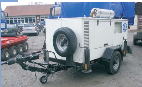
Für die Stromversorgung in aller Welt steht dieses 40 kVA-Generatoraggregat des Herstellers SEB Aggregatebau zur Verfügung.
