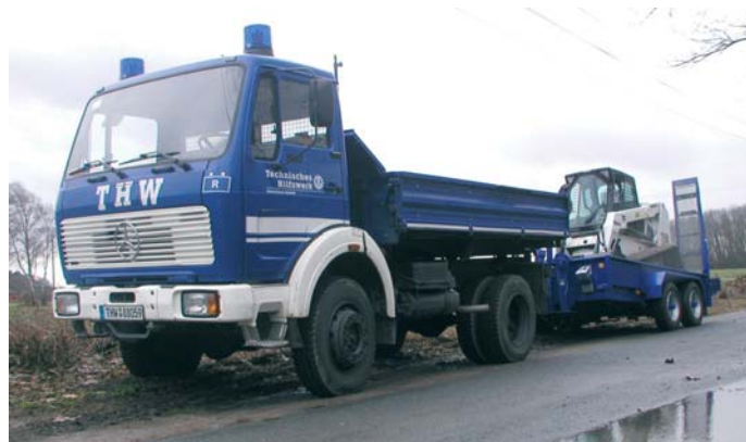
Fabrikneu wurde Ende 2004 ein Prototyp eines Bergungsräumgerätes an das THW Bocholt ausgeliefert. Zusammen mit dem Kipper und einem neuen 2-Achs-Tieflader bildet dieses Fahrzeug die kleinere Version der Fachgruppe Räumen (Typ B). Diesen Bobcat-Lader mit Raupenfahwerk werden wir in einer der nächsten Ausgaben noch näher vorstellen.
