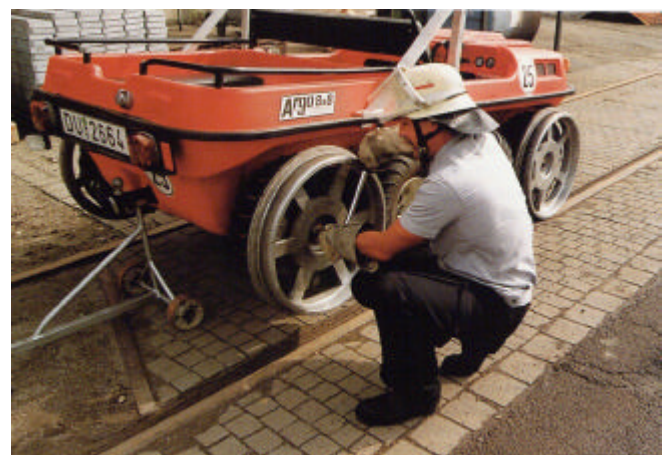
ARGO mit optionalen Schienenrädern für Bahn- und Tunnelrettung (BF Dusiburg)
