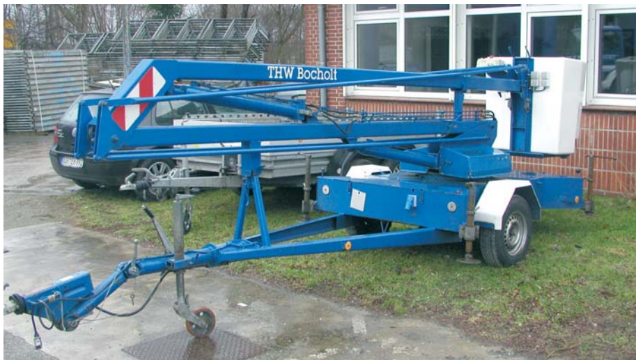
Wenn es mal hoch hinaus gehen soll, dann steht den Bocholtern ein Hubsteiger-Anhänger zur Verfügung. Gerne wird dieser auch als Lichtgiraffe benutzt.
