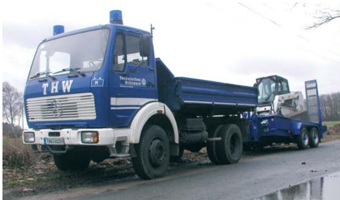
Fabrikneu wurde Ende 2004 ein Prototyp eines Bergungsräumgerätes an das THW Bocholt ausgeliefert. Zusammen mit dem Kipper und einem neuen 2-Achs-Tieflader bildet dieses Fahrzeug die kleinere Version der Fachgruppe Räumen (Typ B). Diesen Bobcat-Lader mit Raupenfahwerk werden wir in einer der nächsten Ausgaben noch näher vorstellen.
